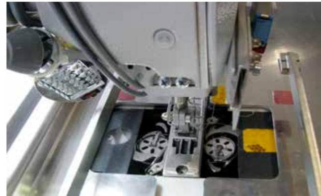
Fig. Campi aperti per il cambio delle bobine
