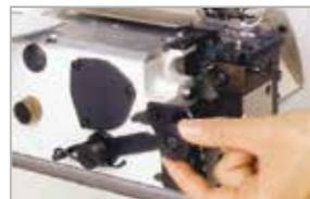
Vite di regolazione del differenziale inferiore regolabile
