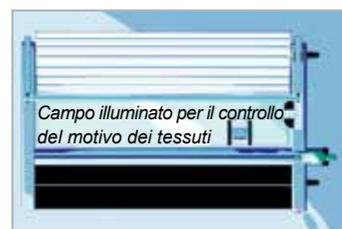
Equipaggiamento standard – Gabbia di roll-off + 2 rulli guida nella parte anteriore. Azionamento davanti
