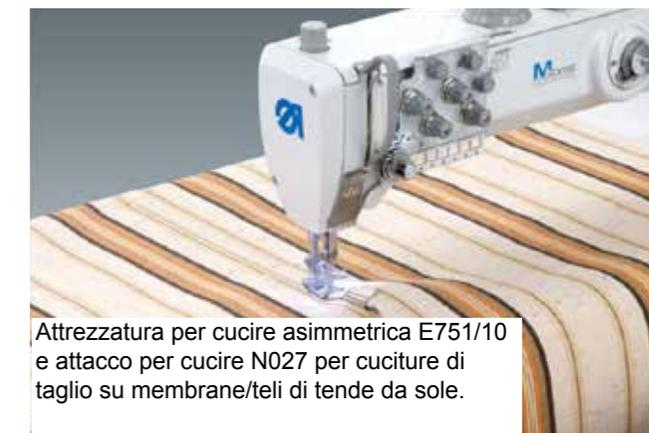
Attrezzatura per cucire asimmetrica E751/10 e attacco per cucire N027 per cuciture di taglio su membrane/teli di tende da sole.
