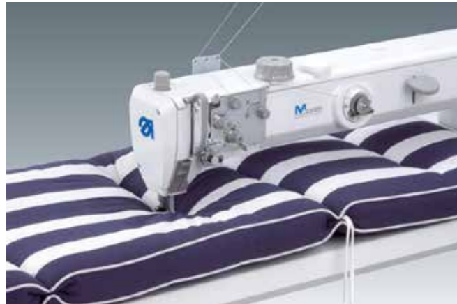
Avec pied en forme de bateau pour les coutures traversantes sur les garnitures de sièges.
