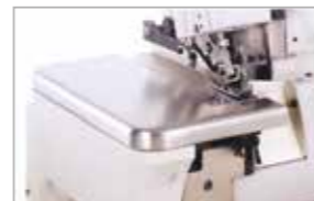
Placas de protección junto con las piezas laterales, se pueden abrir en conjunto.
