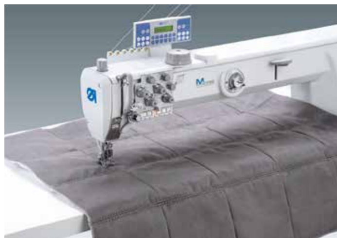
Dispositivo de costura E724/12 para coser piezas de tapicería grandes y voluminosas.
