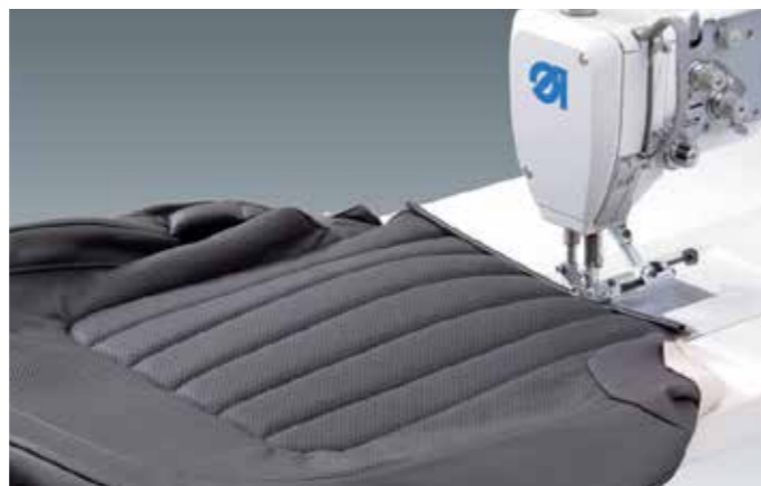
Gancho vertical XXL sobredimensionado (Ø 32 mm) para costura universal.
