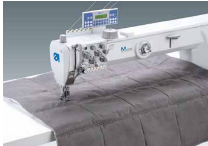
Näheinrichtung E724/12 für Aussteppnähte an großflächigen, voluminösen Polsterteilen.
