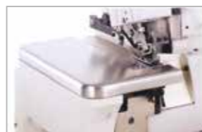
Deckplatte mit dem Seitenteil kombiniert, welche gemeinsam geöffnet werden können
