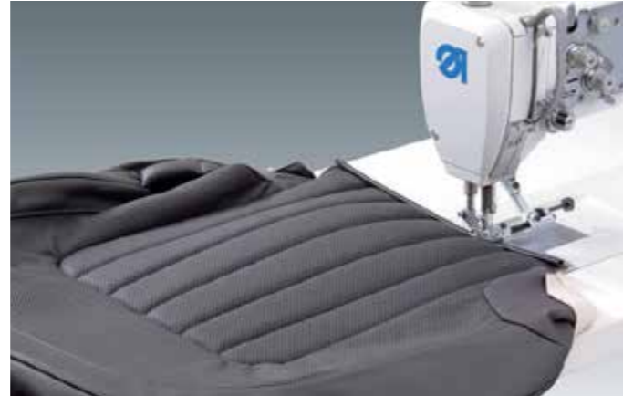
Übergroßer XXL-Vertikalgreifer (Ø 32 mm) für universelle Näharbeiten.
