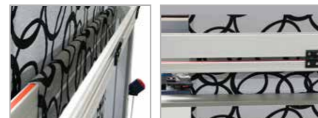
Nachholbalken S und MS für eine zusätzliche Nachholhöhe von 2 m und mehr, je nach Gerätehöhe.
