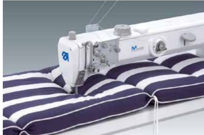
Mit Schiffchenfuß für Durchsteppnähte an Sitzauflagen.
