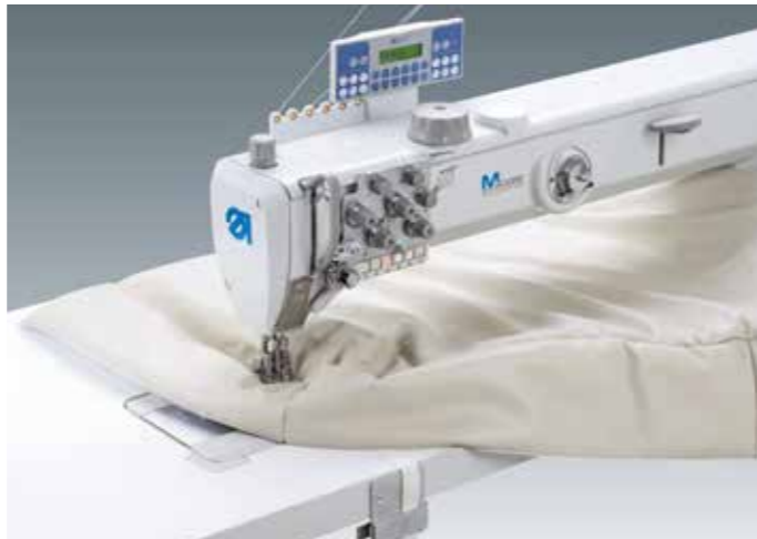
Näheinrichtung E724/12 für Zweinadel-Ziernähte an besonders großflächigen wattierten Leder-Polsterbezügen.
