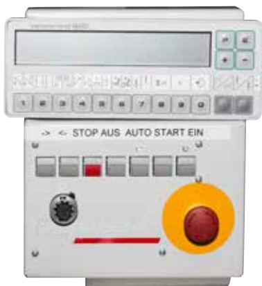
Display oben für Nähkopf Funktionsdisplay mit Not-AUS unten
