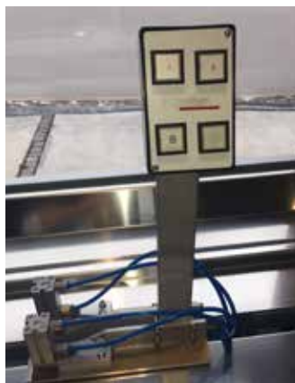
Klammern rechts mit Bremse Funktionsdisplay Klammer L/R/Bremse
