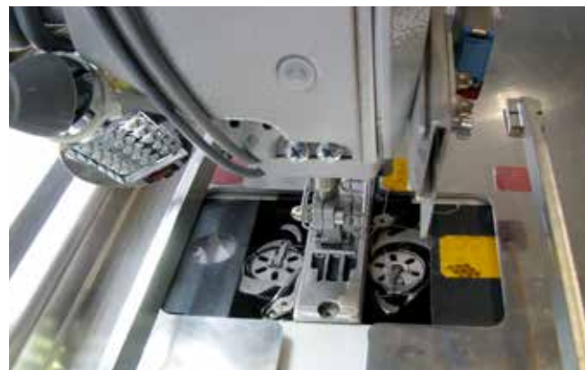
Abb. geöffnete Felder zum Spulenwechsel
